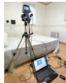
サーモカメラによる断熱診断
